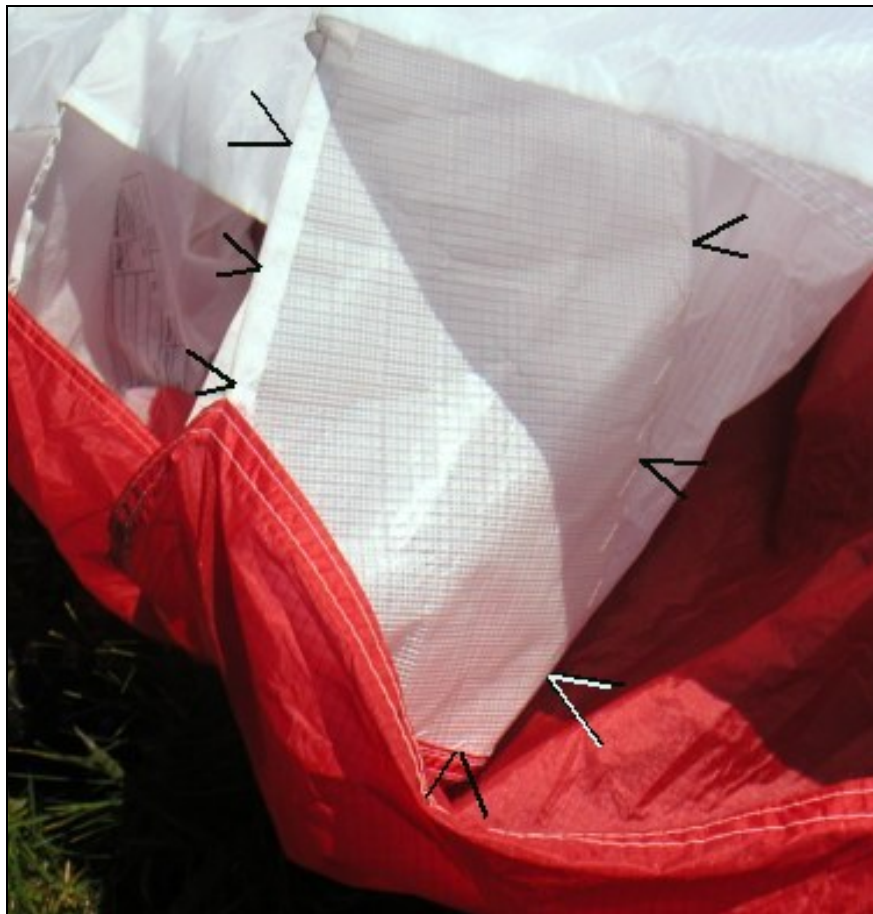
Figure C6 : renforts de tissu enduit de Mylar.
