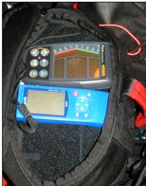
Figure C32 : En haut appareil électronique assemblant un altimètre et un variomètre. En bas un GPS. Les deux instruments se trouvent fixé sur la poche externe ventrale d'un secours.
