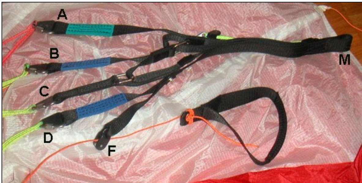
Figure C12 : Elévateurs à 4 sangles A à D. F = petite sangle du frein (commande). M = extrémité qui se fixe au mousqueton de la sellette.
