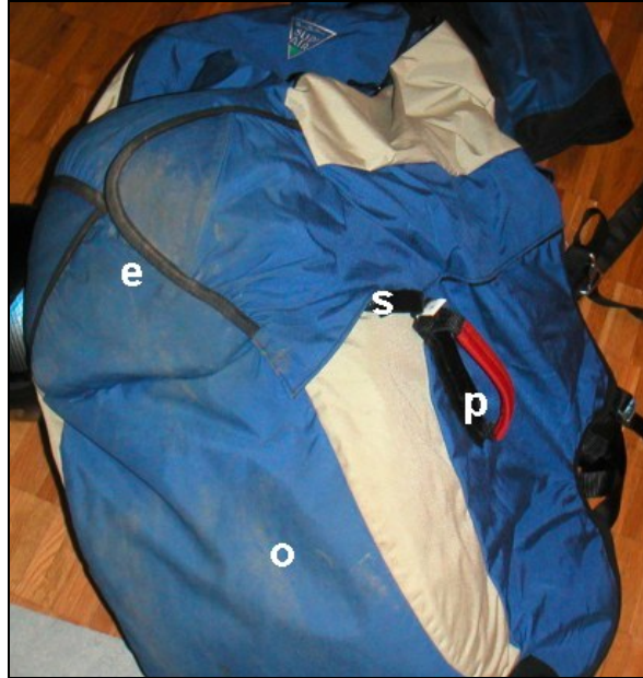
Figure C30 : Exemple de pod dans la poche externe postérieure d'une sellette. e = poche externe, o = mousse bag, s = sangle de liaison entre le pod (caché dans la poche externe) et p = poignée d'extraction.
