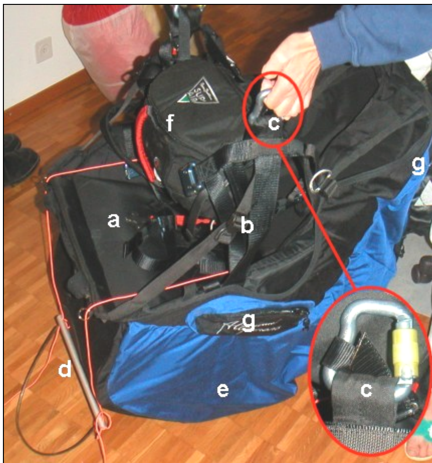
Figure C21 : Exemple de sellette avec airbag, a = partie inférieure rigide (planchette), b = sangle latérales convergeant vers le mousqueton (c). d = étrier de l'accélérateur, e = protection dorsale, f = parachute de secours (ici ventral), g = poches de rangement, latérales et dorsale.
