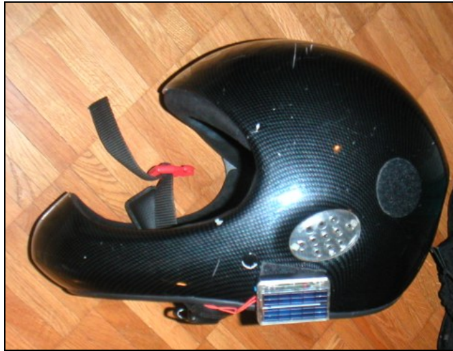
Figure C31 : casque intégral pour le vol libre. Le petit appareil avec cellules solaires, placé au bord inférieur et latéral du casque, est un petit variomètre acoustique sans pile, puisant son énergie électrique du soleil : légèreté et efficacité.
